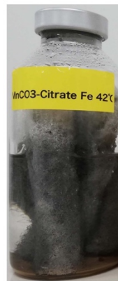
図5. 嫌気的マンガン酸化菌集積培養。不織布に黒色化したマンガン酸化物が形成
