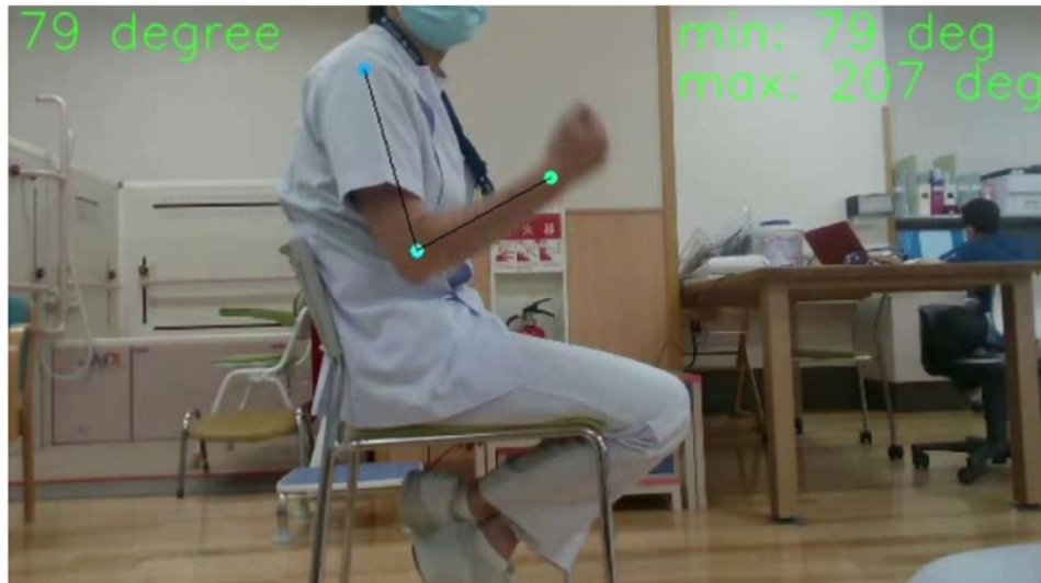
図 2 開発した関節角度計測システムの様子
