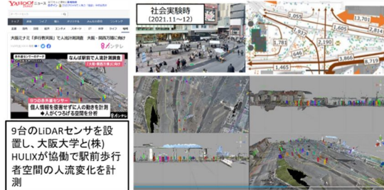
9台のLiDARセンサを設置し、大阪大学と(株)HULIXが協働で駅前歩行者空間の人流変化を計測 国土交通省「デジタル社会に対応したエリアの価値向上 取組み事例・アイデア集」掲載 なんば駅周辺道路空間再編社会実験における人流計測
