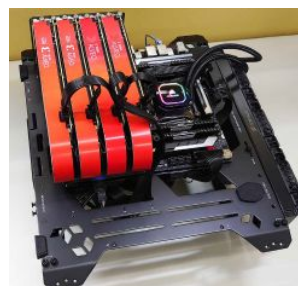
図1 電子ホログラフィ専用計算機システムの全容。
