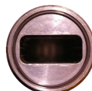
(b) 加速管断面
