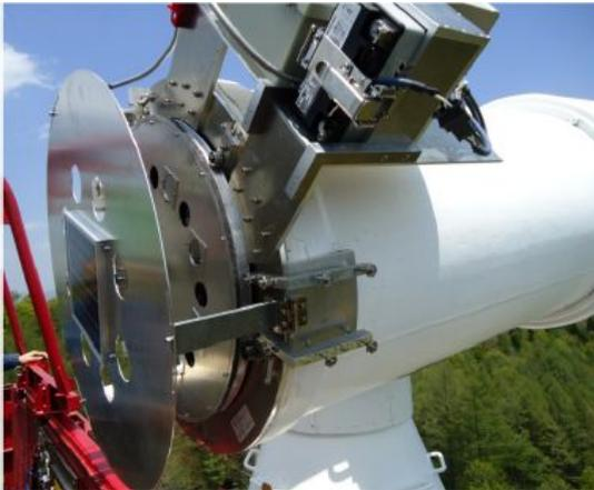
図1. ドームレス太陽望遠鏡の開口に取り付けられた機械偏光特性計測用の偏光板自動回転装置
