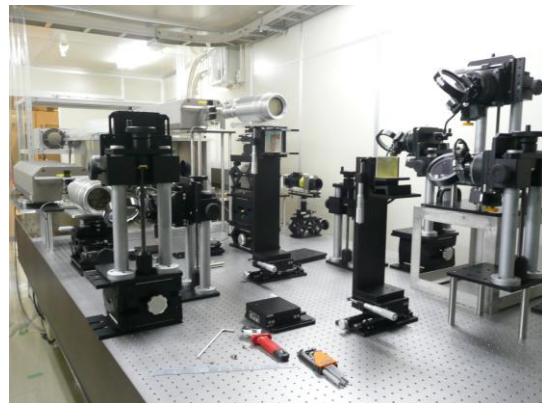
図 2. レーザー同時平行入射システムの光学系
