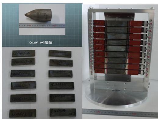
図 4 Cu<sub>2</sub>MnAl 大型単結晶 (左上) とそれを切断した単結晶片 (左下)。それを組み込んだ偏極中性子モノクロメータ (右)
