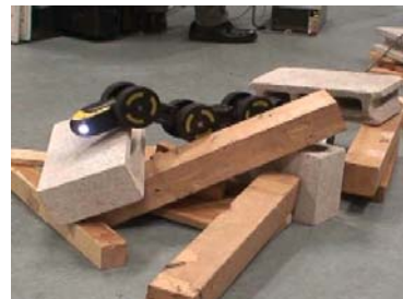
図5 トルクセンサを用いた地形適応 (ロボットは ACM-R4.2)
