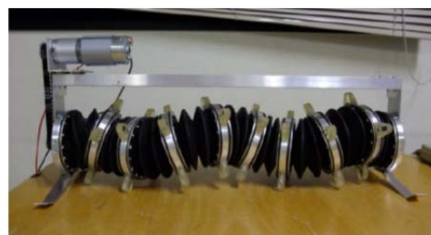
図11 推進力を全身で発生する「Surface wave mechanism」
