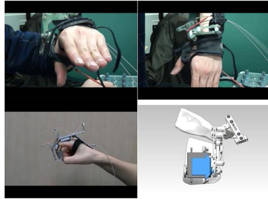
図7 拇指CM関節アシスト機構と簡易装着機構
