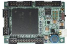
図4 SHマイコンによる小型高速情報処理装置
