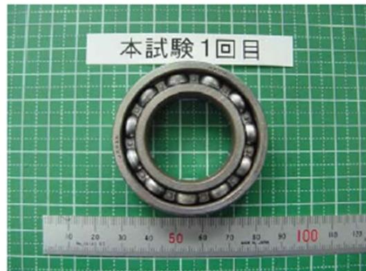
図 2. 軸受け(ボールベアリング)
