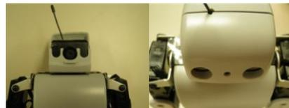
図 1. ロボットに組み込まれた小型カメラ
