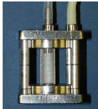
図 1. ePTFE 型人工血管を装着したリアクター内部循環液は中央の人工血管に入り、その壁を通過して周囲に流れリアクターを離れる。壁を通過することにより、人工血管の内面に高密度コラーゲン細線維組織と血管内皮細胞をライニングすることが出来る。
