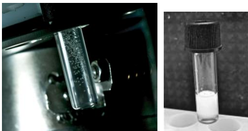
6000回転で攪拌している瞬間(左)。ミセル製剤リプルを攪拌した直後の写真(右)
