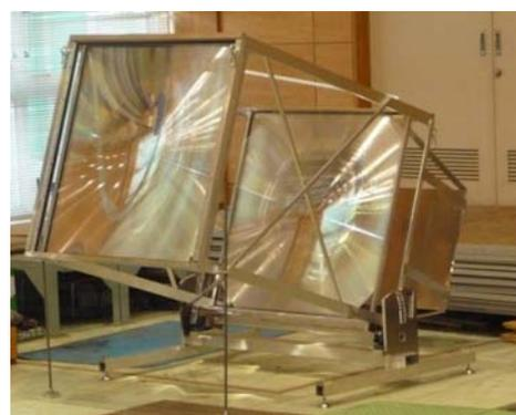
図7：TA-EUSO望遠鏡の光学系
