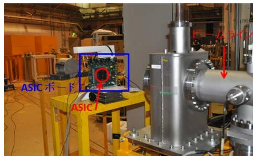
図6：放射線医学総合研究所 HIMACでの重粒子線による試験の様子
