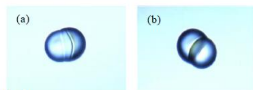
Fig.3 水-油の衝突により精製されたハイブリッド液滴構造。
