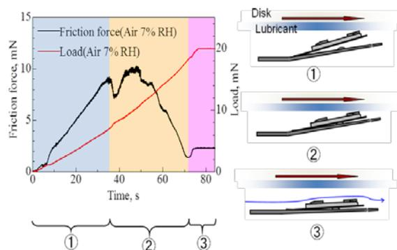
(3) 磁気ヘッド空気軸受表面の吸着
