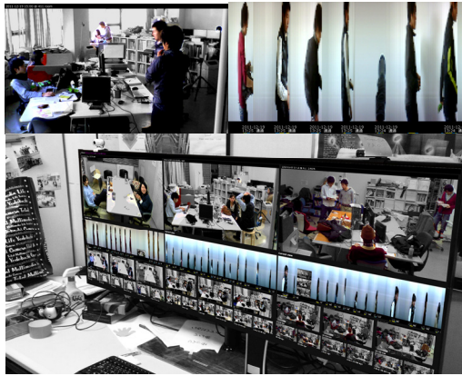
図3 スリットカメラと画像センシングによるアウェアネス支援
