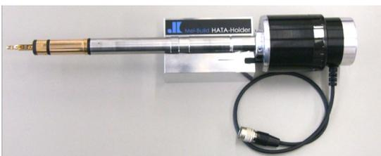
図2: 本研究で設計・製作した、3軸試料方位調整機能を有する電子顕微鏡ホルダー。JEM-3200FSK型TEMでは、ホルダー一軸を中心に360°全方位回転が可能。
