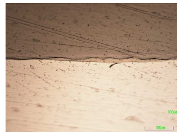
図 15 AZ31(焼なまし材; 0.3mm 厚)を中間材に用いた場合の実験結果 (Ti; 0.5mm 厚、 \alpha=20^\circ , D=45\text{mm} , SOD=0.2\text{mm} )
