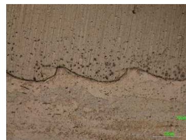
図11 アルミニウム合金とマグネシウム合金の接合界面組織（ \alpha=30^\circ, D=25\text{mm}, \text{SOD}=0.2\text{mm} ）
