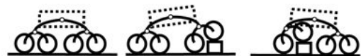
(a) LUBOT-1号機で用いた前進・後退対称ロッカー・ボギー・サスペンション。
