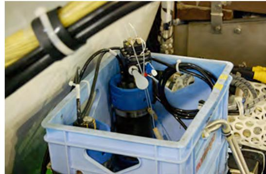
図4 差分計測のために「しんかい6500」に搭載されたpHセンサ
