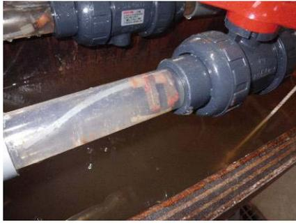
図3 海水循環浸漬実験装置の配管内に設置された試験片
