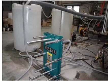
図5 熱交換器を用いたプレート防食実験
