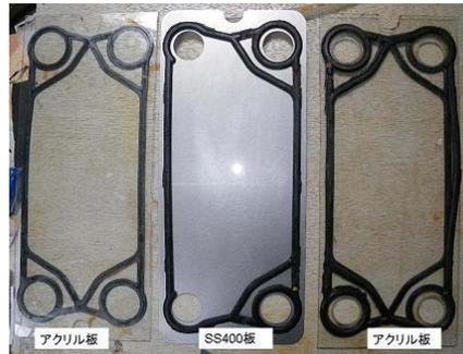
図6 熱交換器要プレート実験板
