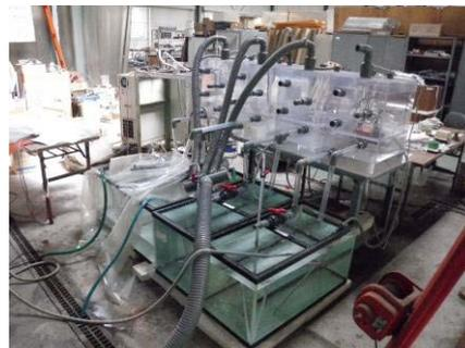
図1 海水循環浸漬実験装置
