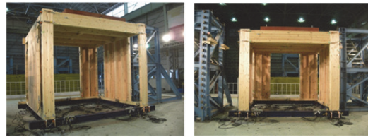
(a)低剛性高靱性タイプ (b)高剛性低靱性タイプ 図8 震動台を用いた実験の状況
