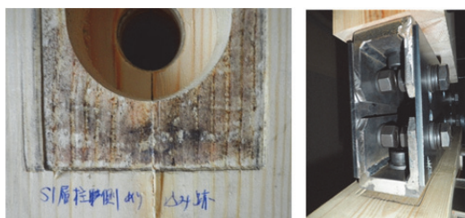
柱側面でのめり込み跡 HTB 接合部での迂り変形 図 18 実験終了後の接合部の状況
