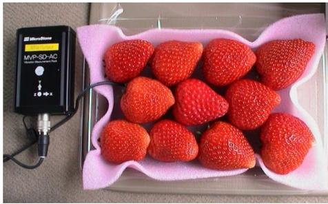
a) イチゴ型 3 軸加速度センサの設置状態
