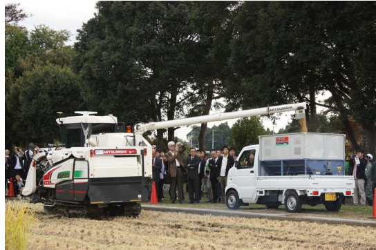
図2 収穫した穀粒の自動排出システム
