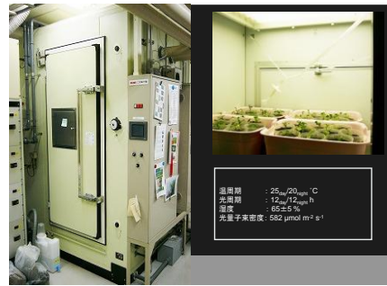
図3 グロスチャンバーと栽培条件
