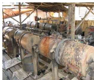
図2 ゴロンドンを用いた金鉱石からの金の採取
