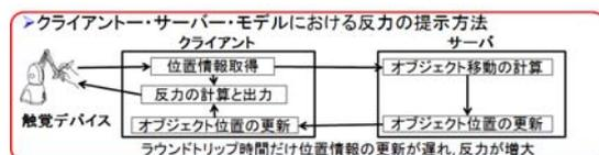
図 3: クライアント・サーバー・モデル
