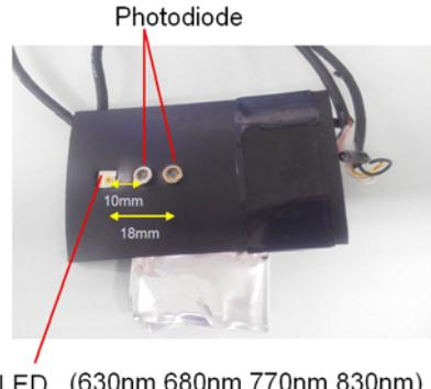
図2 試作した送受光プローブ
