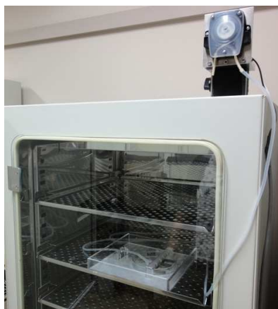
図5 心筋単層の積層培養に用いる培養液灌流バイオリアクタ
