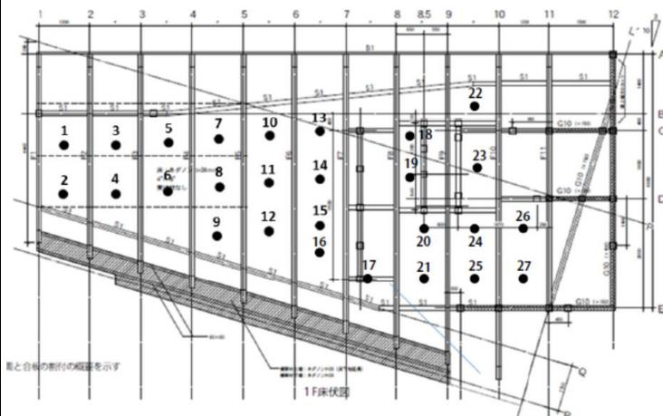
図 2 加速度センサの配置（27 個）
