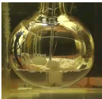
写真2 減圧下(約30kPa)で室温でも沸騰しているアセトン
