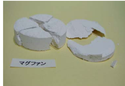
図1 出来上がりの丈夫さに問題のある化学肥料で製作した自然放射能線源
