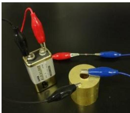
図 3. 乾電池を電源とした電解重合系
