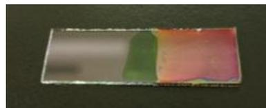
図 4. PT 膜上に PCBM をスピンのコーターした ITO ガラス基板
