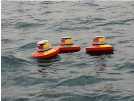
写真1 漂流ブイ調査の様子
