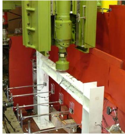
写真1 重錘落下衝撃実験状況
