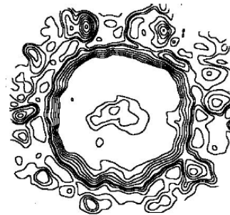
図6. 粒状体界面への渦輪の衝突による形状。等高線による表示で，ドーナツ状の凹みの中央部は凸部に，また，その外側に小さな凹みがほぼ等間隔に形成される。
