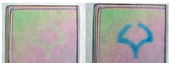
図 8 ITO 基板上における 4a (左) から CuPc (右) への熱変換。加熱条件は 85°C で 1 分間。
