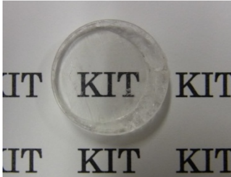
図 7 アルコゲル置換法による PMMA 複合材の調製
