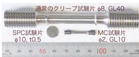
図 2 SP クリープ試験片など
