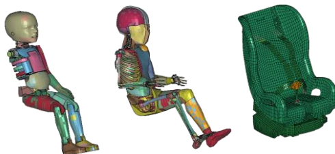
図4 ダミー(Hybrid III)、人体、CRSモデル
