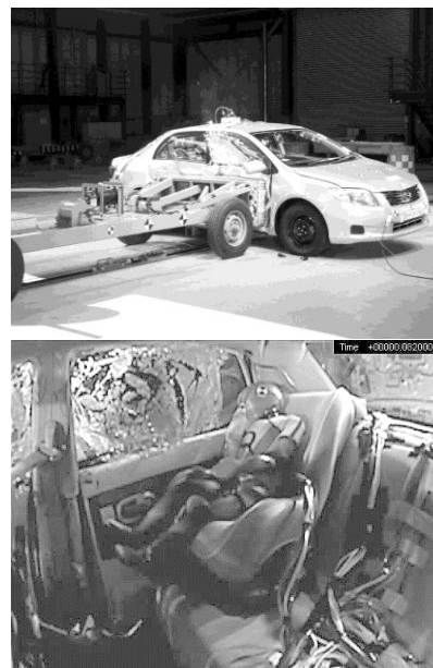
図 1 実車側突試験 (頭部は CRS シェル内に留まる)
