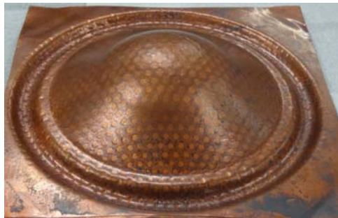
図 6 球頭パンチにより張出成形された多孔質積層板 (接合温度 673K, 正三角形格子孔配列, 孔直径 2.5mm, スキン層厚さ 0.2mm, 張出高さ 27mm)
