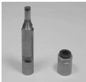
図 2 PCD 製打抜きパンチとダイ
