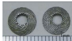
③半径流マイクロタービン翼
