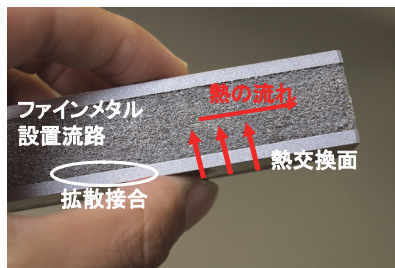
図1 ファインメタルと熱移動の模式図
