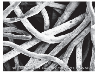
図3 アルミニウム繊維層のSEM写真
