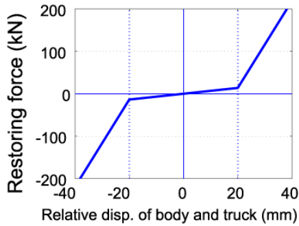
図 11 車体台車間の左右動ストップの復元力特性
