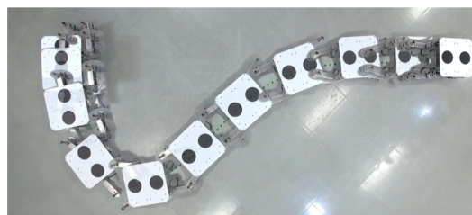
図 8 4 又移動機構の経路追従動作
