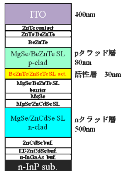
図 1 発光素子の構造。
