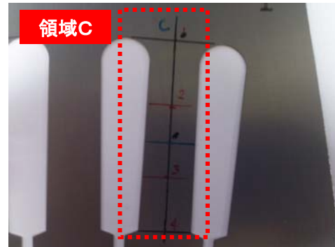
(a) 残留応力、バルクハウゼン信号測定領域 (測定領域C)
